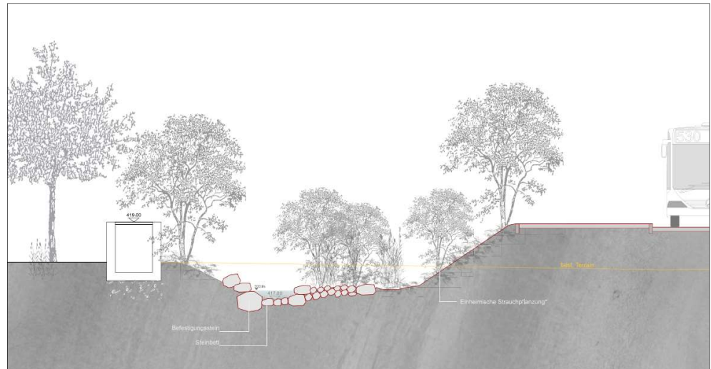
Abbildung 13: Gestaltungsvorschlag Renaturierung Siehbach [1]
