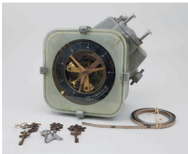
Abb. 8 Wasserstandsmesser, Franz Rittmeyer AG Zug, Mitte 20. Jahrhundert.
