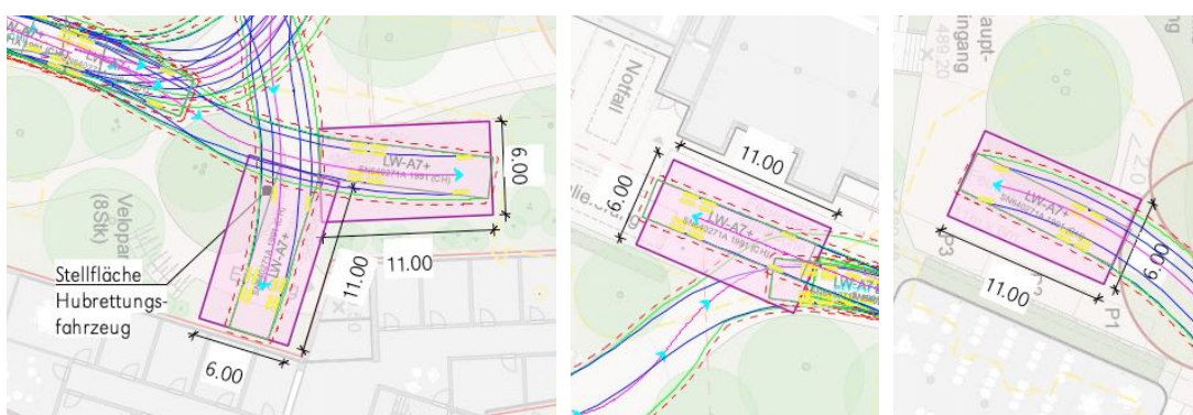
Abbildung 13: Befahrbarkeit Feuerwehruzufahrt Ausschnitt Stellfläche
